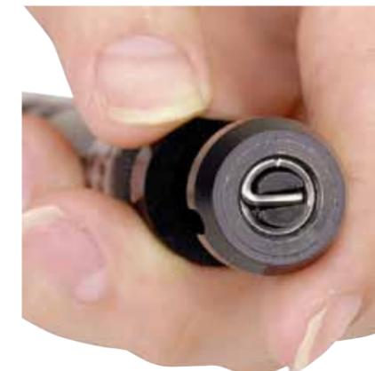
③ タップ穴の中心に直角に挿入工具を立てて、挿入工具を揺らさないように軽くハンドルを右に回すと、スクリューが挿入されます。ピッチ飛び不良にならないように、ハンドルは押し付けずに軽く回して下さい。
