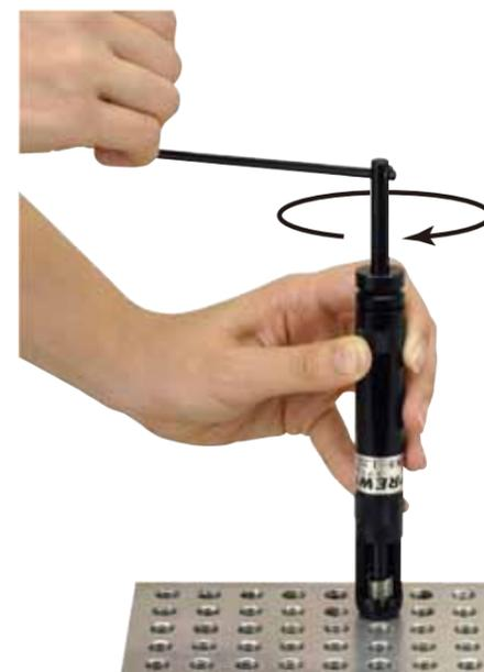
⑤ タングは挿入工具で折らないでください。マグネット付き折取工具M-TBOをタングにあてがいハンマーで短打します。
