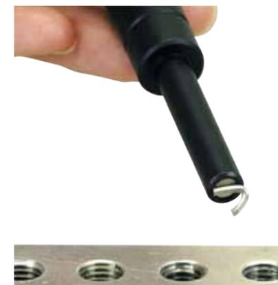
注) 挿入工具で右回転するとスクリューがしぼられています。その状態で上から力を加えると、ピッチ飛びを起こしますので注意してください。
